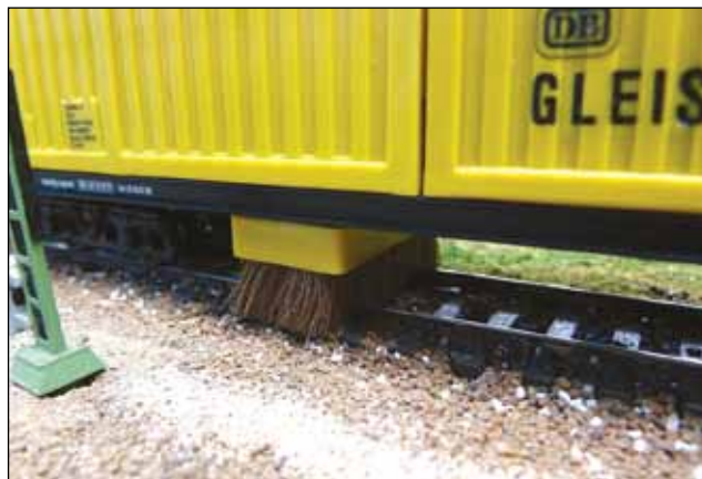
Die seidenweiche Bürste schliesst sich eng um die Gleisprofile, so dass der Staubsauger kräftig den ganze Staub hochzieht.
