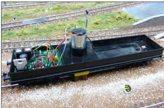
Der Staubsaugerwagen ohne Deckel und Sammelbehälter. Links die Elektronik und im Zentrum der vertikal montierte Faulhaber-Motor von der Staubsauger
