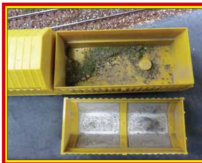
Der Staubaufgang wurde sehr überraschend. Nach unsere Meinung haben wir noch nie so eine effektive Schienenreinigung gesehen. Die Gleise werden sauber geputzt und die Gleise schön geschliffen. Diese Reinigungswagons können wir stark empfohlen werden.
