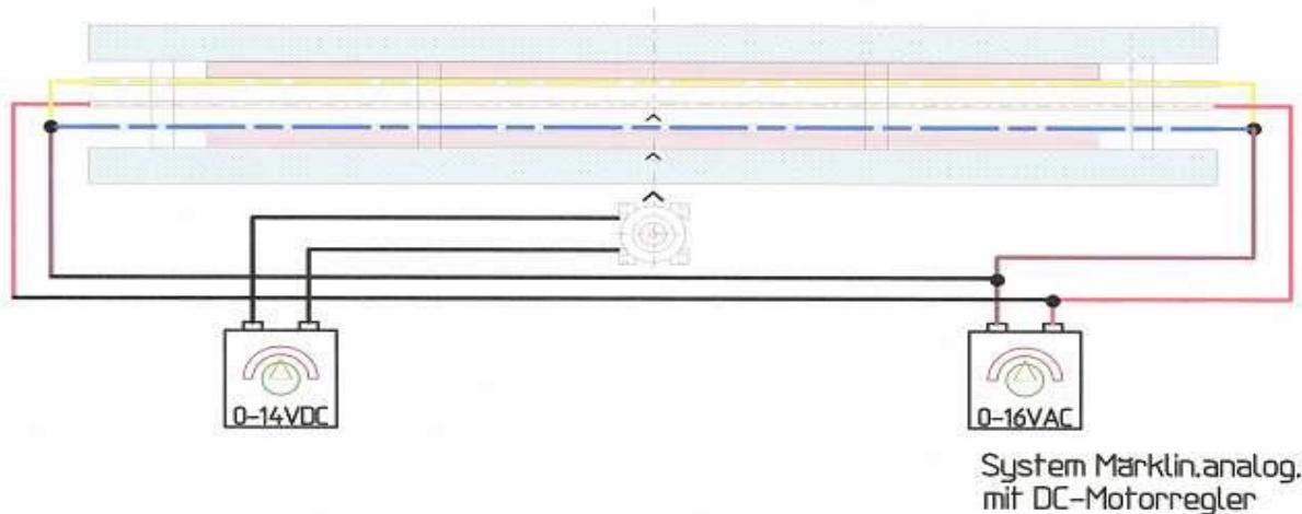
Art.-Nr. 9301 und Art.-Nr. 9304 Einbaugerät System Wechselstrom (AC~) analog, **mit Lux-Adapterplatine**
