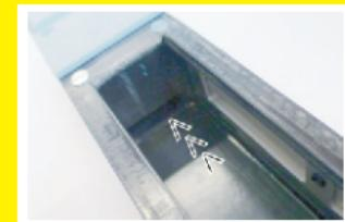
**Tipp:** Zur flacker- und verschleißfreien Kontaktierung alle stromübertragenden Metallteile im Drehgestell (ggf. am Fahrzeugboden) regelmäßig reinigen und mit Lux-Kontaktöl (Art.-Nr. 8887) oder Lux-Kontaktcreme (Art.-Nr. 8886) behandeln.
