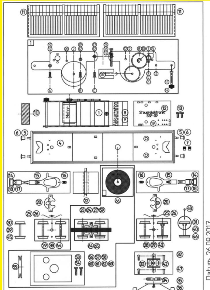
**Ersatzteilliste für den H0-Schienen- und Oberleitungsschleifwagen**
